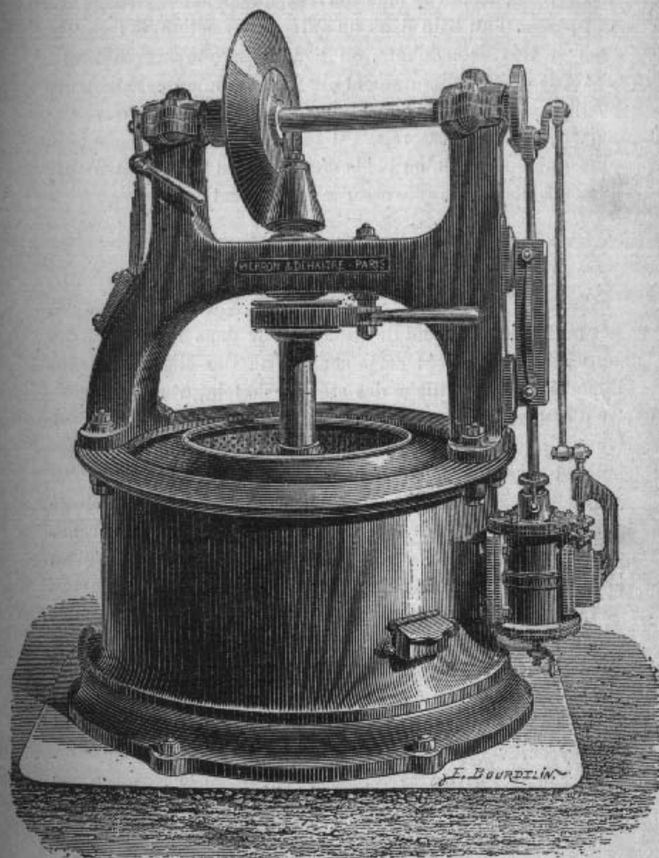
FIG. 53. — Essoreuse Dehaitre avec son moteur.
