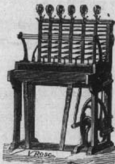
FIG. 67. — Cannelière à rubans, d'après MM. Sallier aîné et C°.
