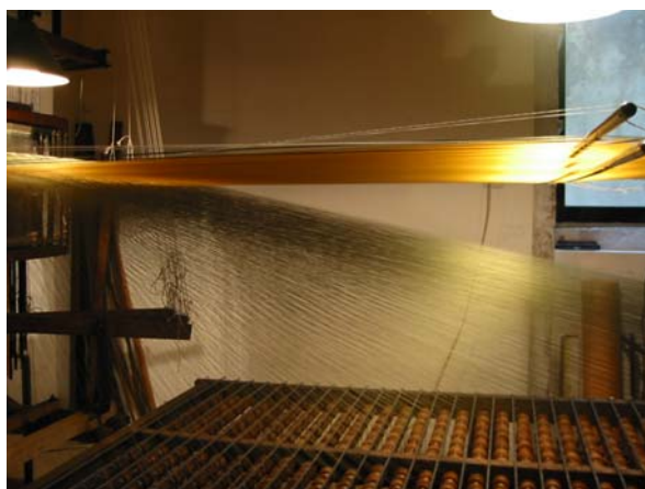
Les fils poil remontent de la cantre à velours. Atelier Agnès Alauzet
