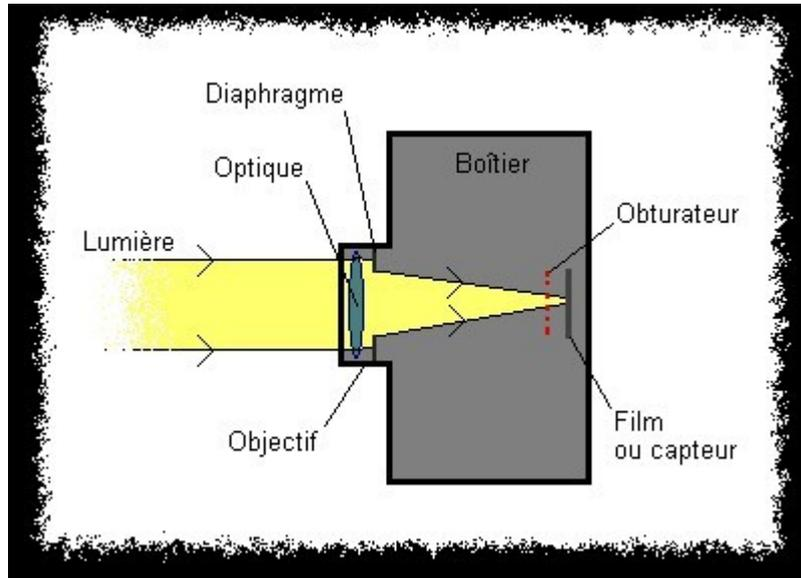
Schéma de principe : on remarque le capteur, le diaphragme et l'obturateur
